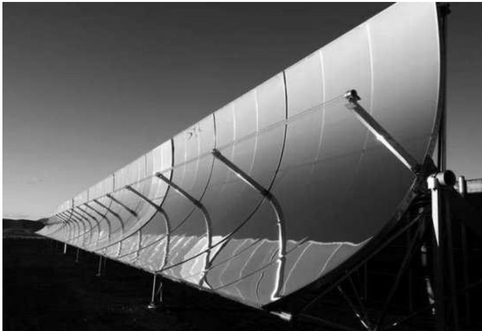
Figura 5. Captador solar térmico de concentración.
